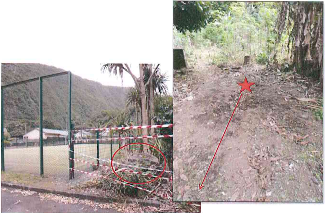
Figure 7 - Bloc éboulé dont la trajectoire s'est arrêtée derrière le terrain de sport (voir localisation sur la Figure 6). Photo de droite : l'étoile marque l'impact du bloc (après rebond ?) et la flèche la trajectoire du bloc qui a poursuivi sa course sur plus de 10 m.
