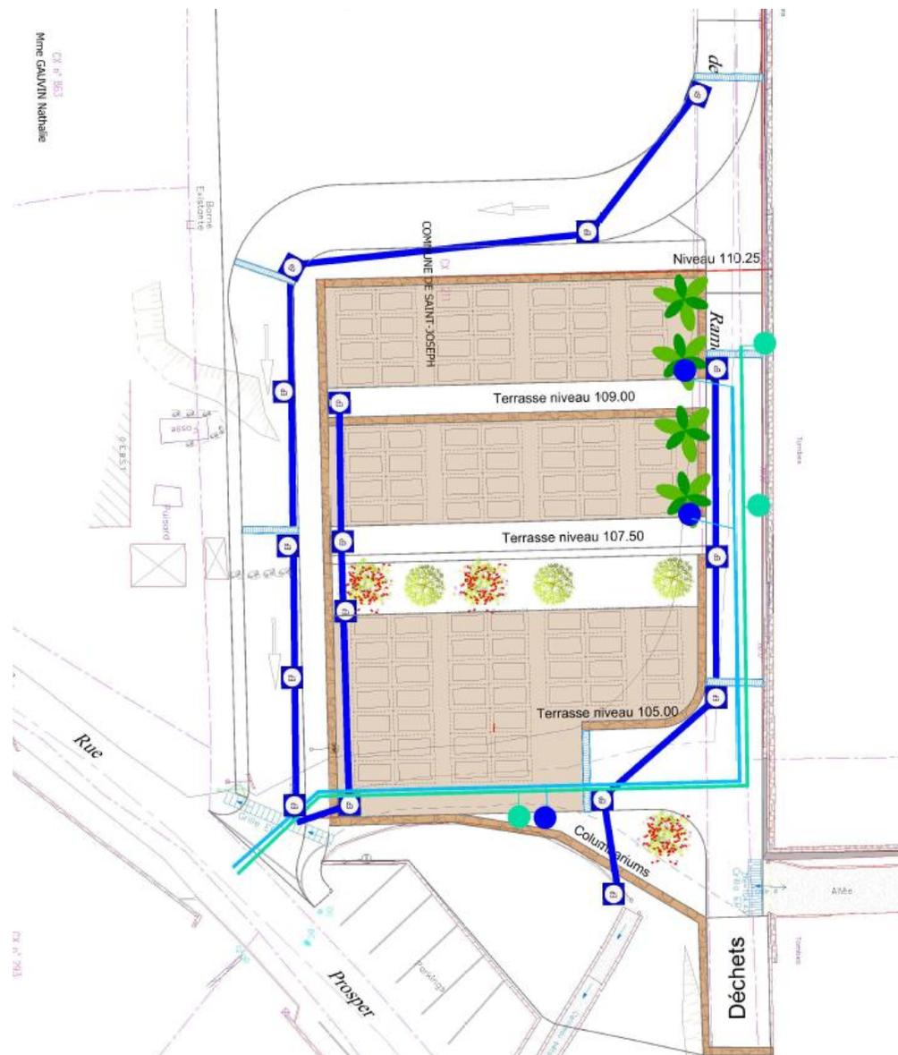
Plan de masse du projet urgent (points bleus foncés : bornes fontaines ; points bleus clairs : vannes pour l'arrosage ; réseaux bleus foncés : réseaux d'eau pluviale ; réseaux bleus clairs : réseaux d'adduction en eau potables)
