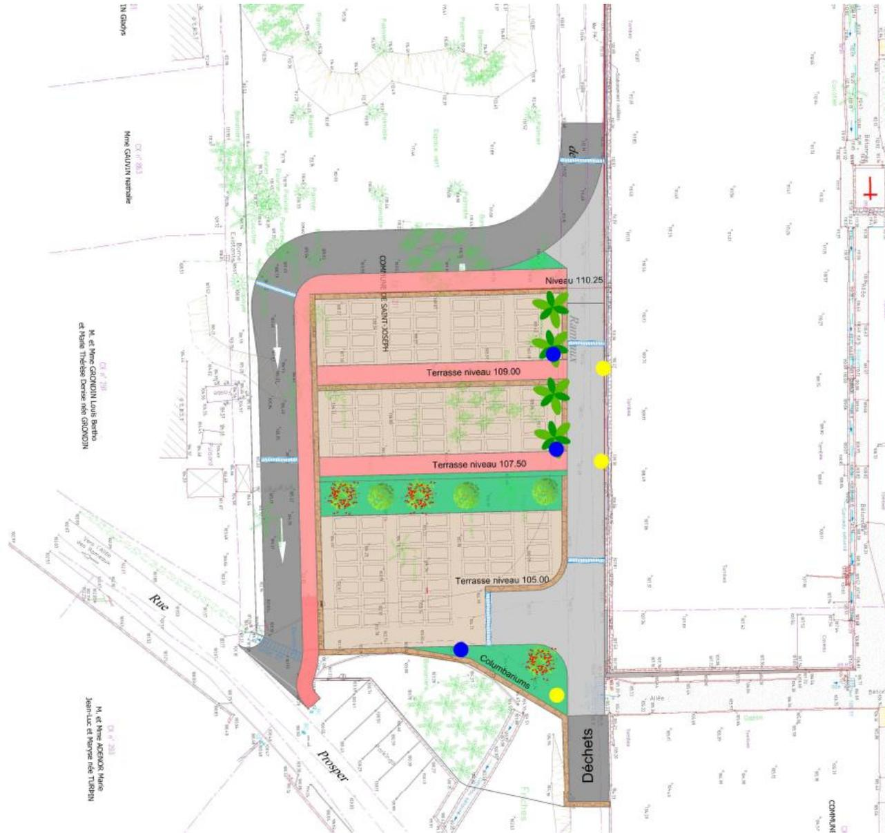
Plan de masse du projet urgent (points bleus foncés : bornes fontaines ; points jaunes : zone d'équipements de collecte des déchets et de mise à disposition de matériaux)
